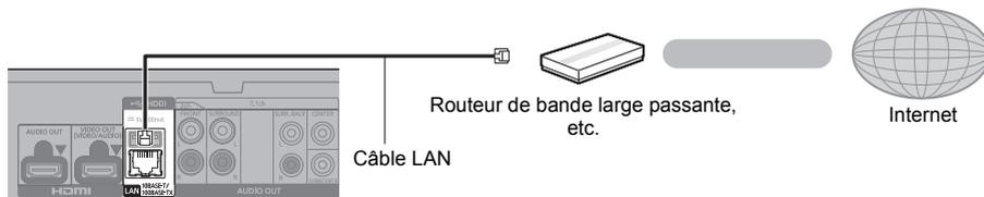
Utilisez des câbles LAN droits de catégorie 5 ou supérieure (STP) pour connecter les appareils périphériques.
