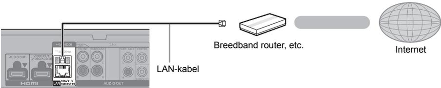
Gebruik rechte LAN-kabels van categorie 5 of hoger (STP) als u een aansluiting op randapparatuur tot stand brengt.
